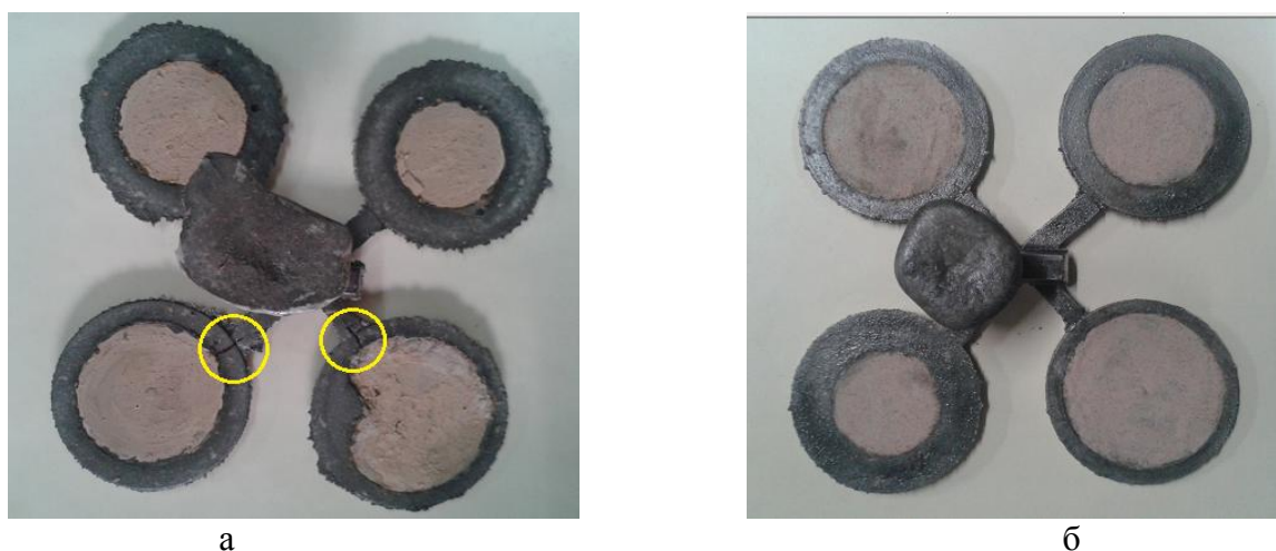
Рис. 4. Наличие трещин в кольцевой пробе: а – без продувки; б – с продувкой и фильтрацией
